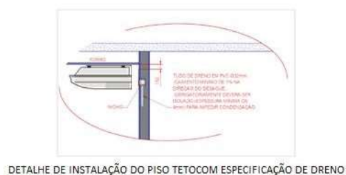
FIGURA 9: DETALHAMENTO DO SISTEMA DE DRENO HI WAL
